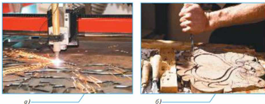
Рис. 3.2. Резание: а — лазером; б — механическими инструментами
