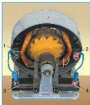
Рис. 8.8. Электрогенератор: 1, 2 — концы обмоток электромагнита; 3, 4 — выходные клеммы
