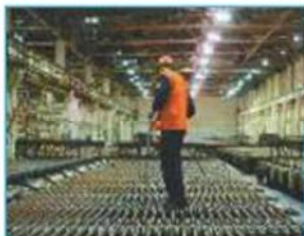
Рис. 5.19. Цех с ваннами для рафинирования меди
