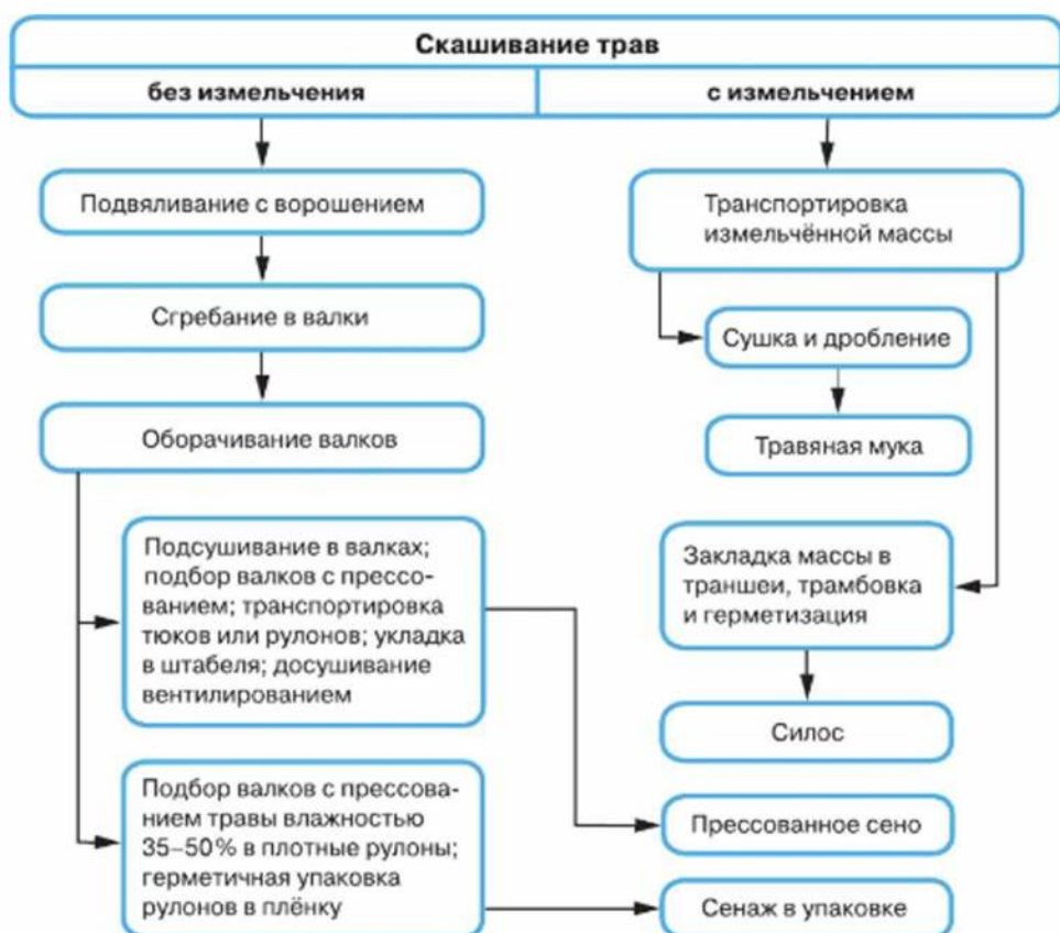
Рис. 11.3. Схема технологий заготовки травяных кормов
