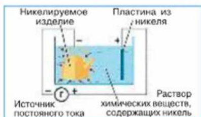
Рис. 5.20. Схема установки для никелирования посуды
